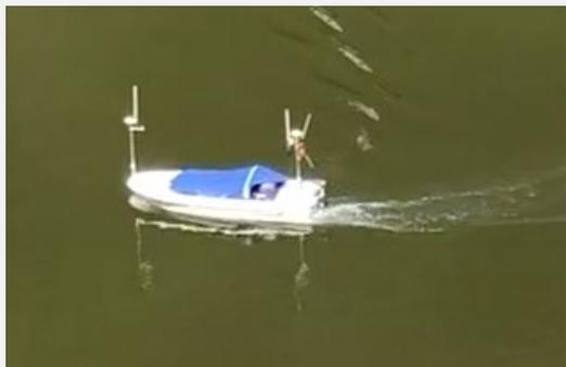
3次元堆砂測量の遠隔化
