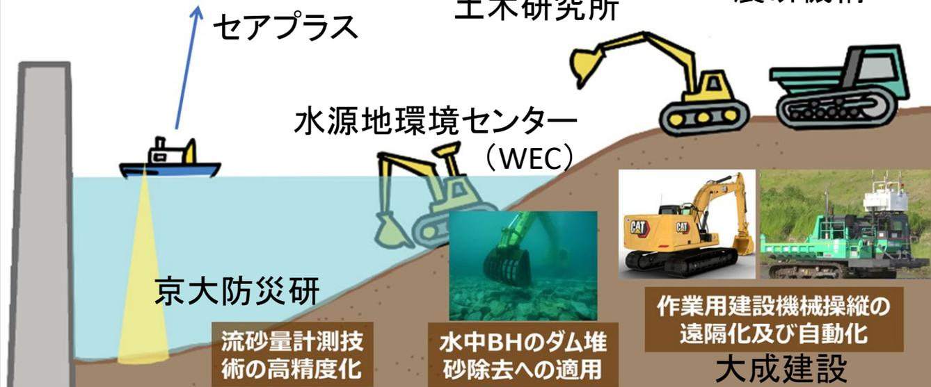
ダム堆砂測量の自動化や堆積土砂に含まれる異物（沈木など）の事前把握、さらに、こうしたデータを活用した土砂の掘削や浚渫作業の自動化や遠隔化などの技術開発を推進。
