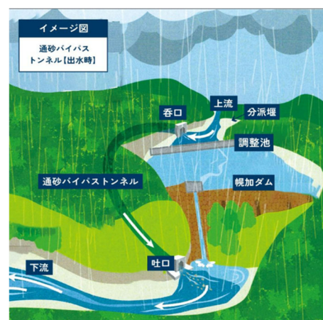
通砂バイパストンネルのイメージ
